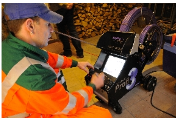
Kontrolle vor Ort: Am Monitor gleich neben dem Zugang zum Hausanschluss wird das Bild der Kamera geprüft.
