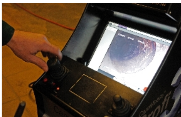
So sieht es innen aus: Die Bilder der Kamera werden an wesentlichen Stellen auf dem Monitor mit Hinweisen versehen.
