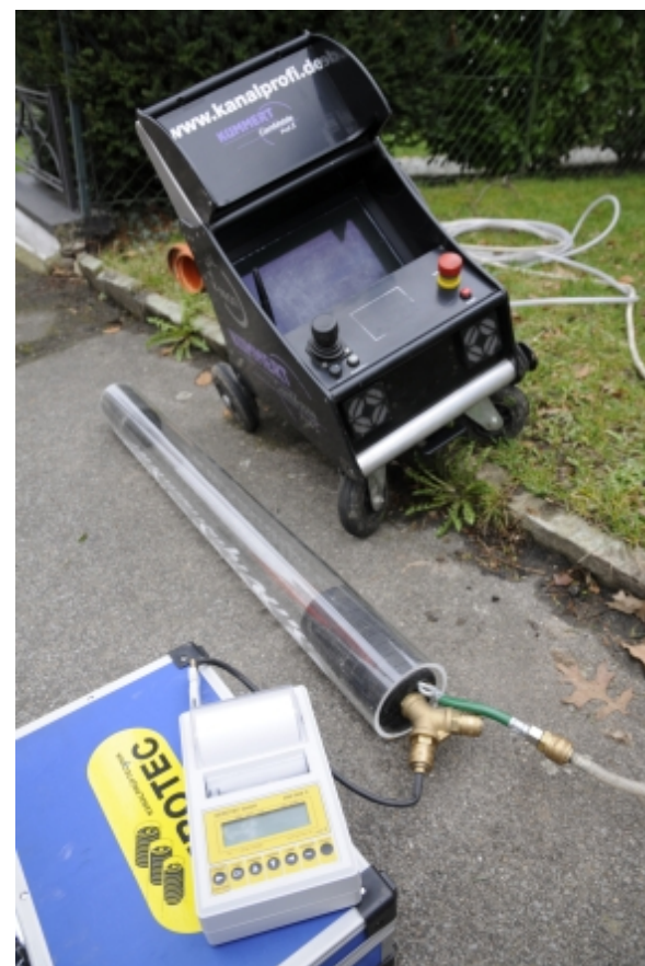
Wenn die TV-Analyse nicht in Frage kommt: Mit diesen Geräten kann eine Druckmessung mittels einer so genannten „Absperrblase“ erfolgen.
