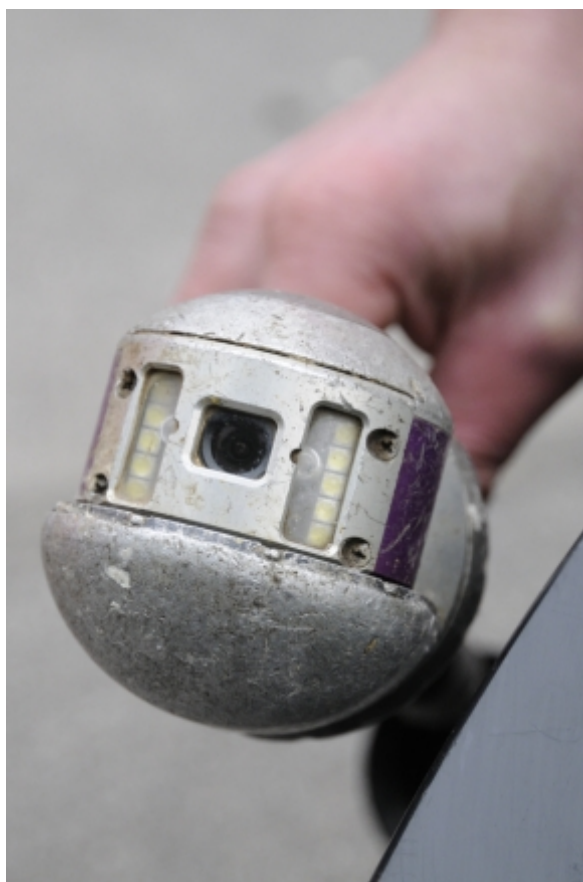
Alles im Blick: Der frei schwenkbare und beleuchtete Kopf der Kamera hat im Kanalrohr direkte Sicht auf mögliche Schwachstellen.
