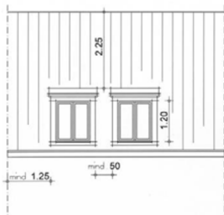
Rückwärtige Ansicht mit neuen Gauben
