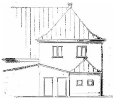
Rückansicht mit historischem und neuem Anbau
