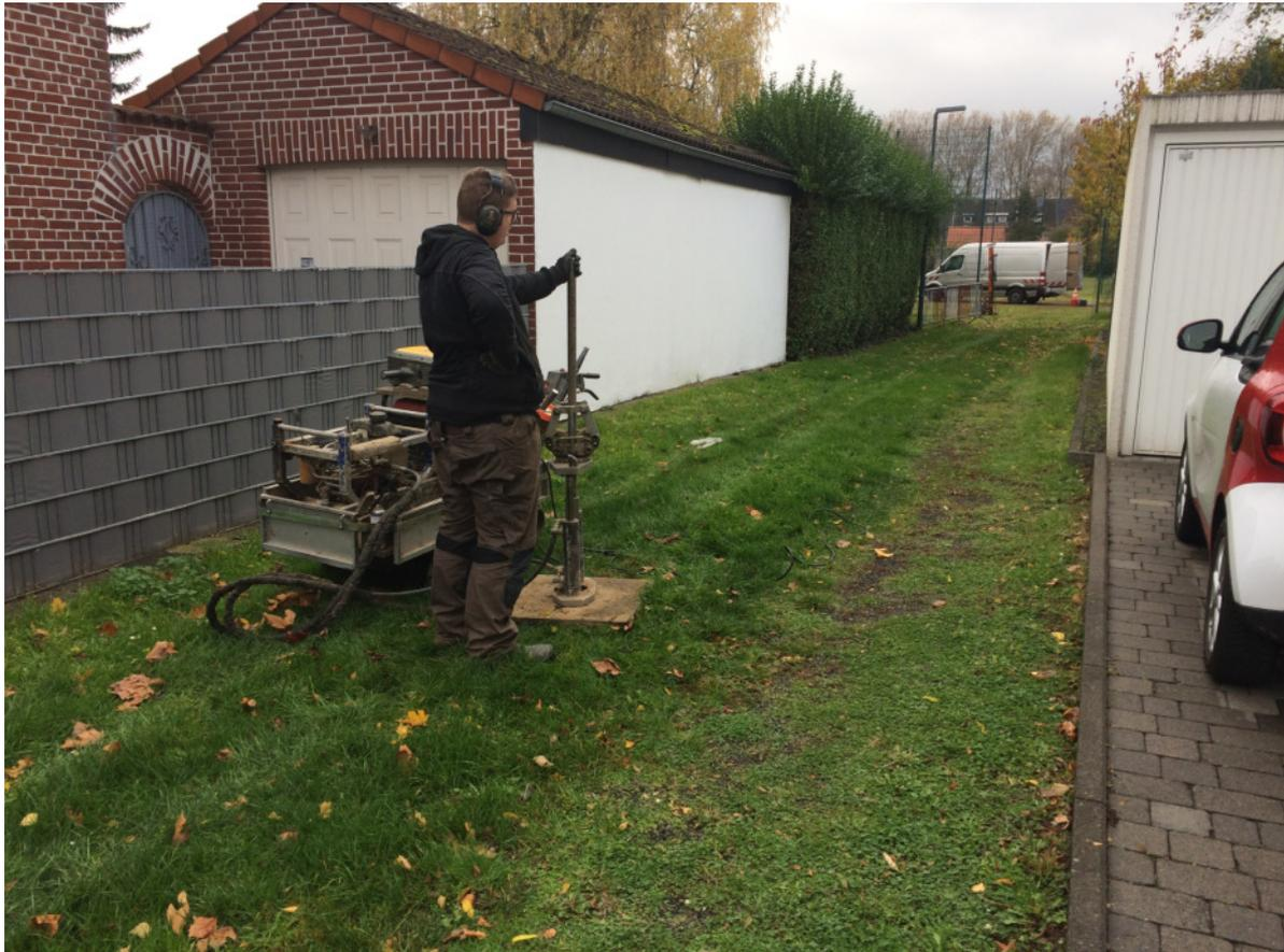
Bild 5: Ausführung RKS 1 am 13.11.2019 (im Hintergrund Ausführung DPL 1)
