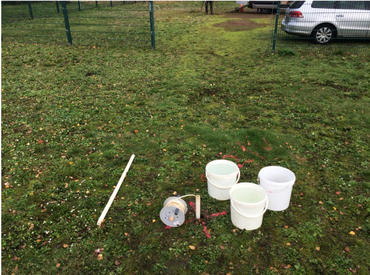
Bild 9: Ausführung des Vevrsickerungsversuchs V1 im Bohrloch der RKS 1 am 13.11.2019
