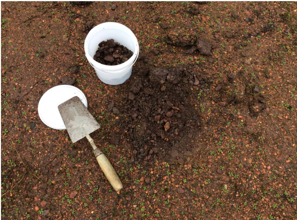
Bild 4: Mischprobennahme aus dem Spielfeldbelag (roter Tonsteinsplitt/-schotter) am 13.11.2019
