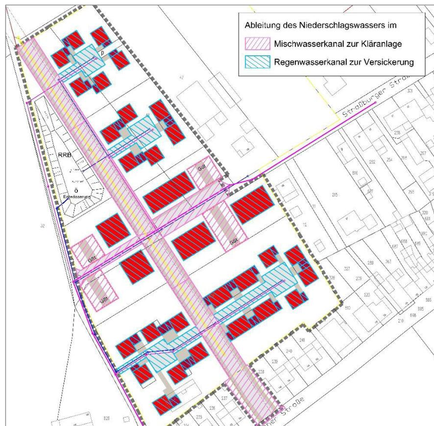
Abbildung 2: Einzugsflächen getrennt nach System
