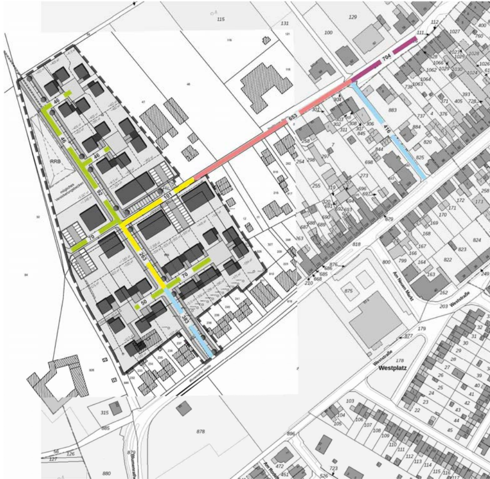
Bild 25: Querschnittsbelastungen der untersuchten Straßenabschnitte [Kfz/24h]
