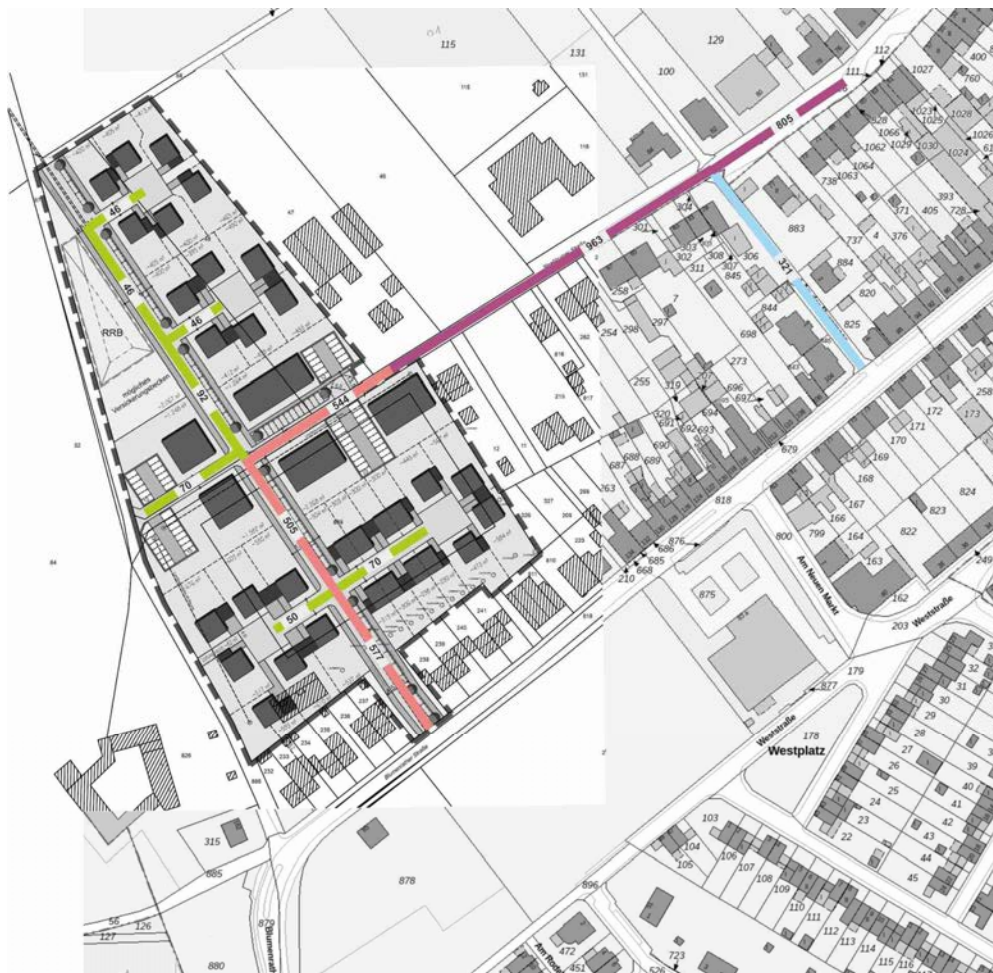
Bild 19: Querschnittsbelastungen der untersuchten Straßenabschnitte [Kfz/24h]
