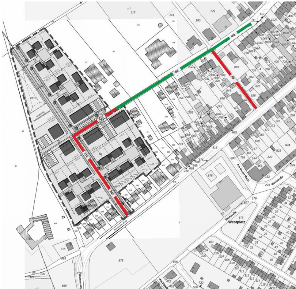
Bild 24: Differenzenplan Erschließungsvariante 3 zu 4 [Kfz/24h]
