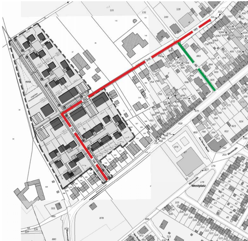
Bild 20: Differenzenplan Erschließungsvariante 1 zu 4 [Kfz/24h]
