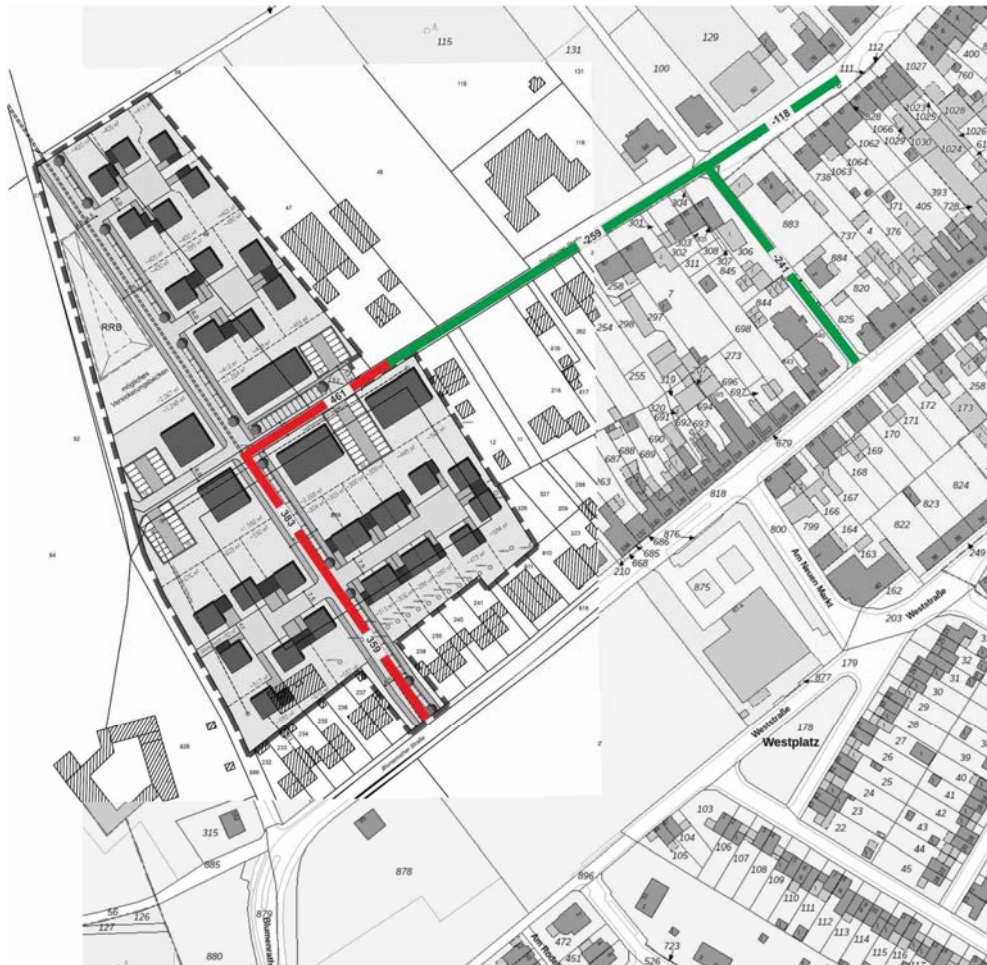
Bild 22: Differenzenplan Erschließungsvariante 2 zu 4 [Kfz/24h]
