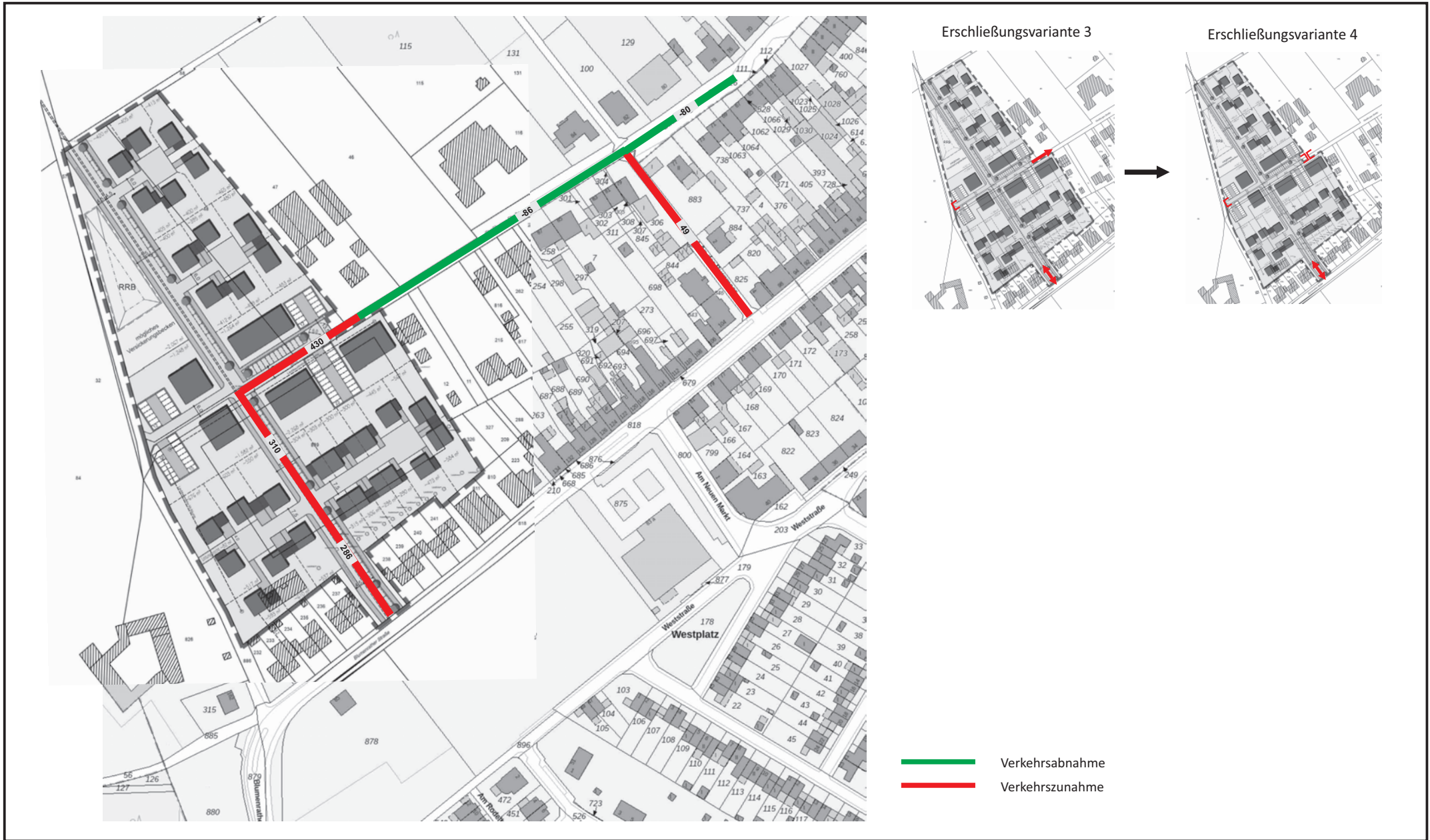
Differenzenplan Erschließungsvariante 3 zu Erschließungsvariante 4 [Kfz/24h]
