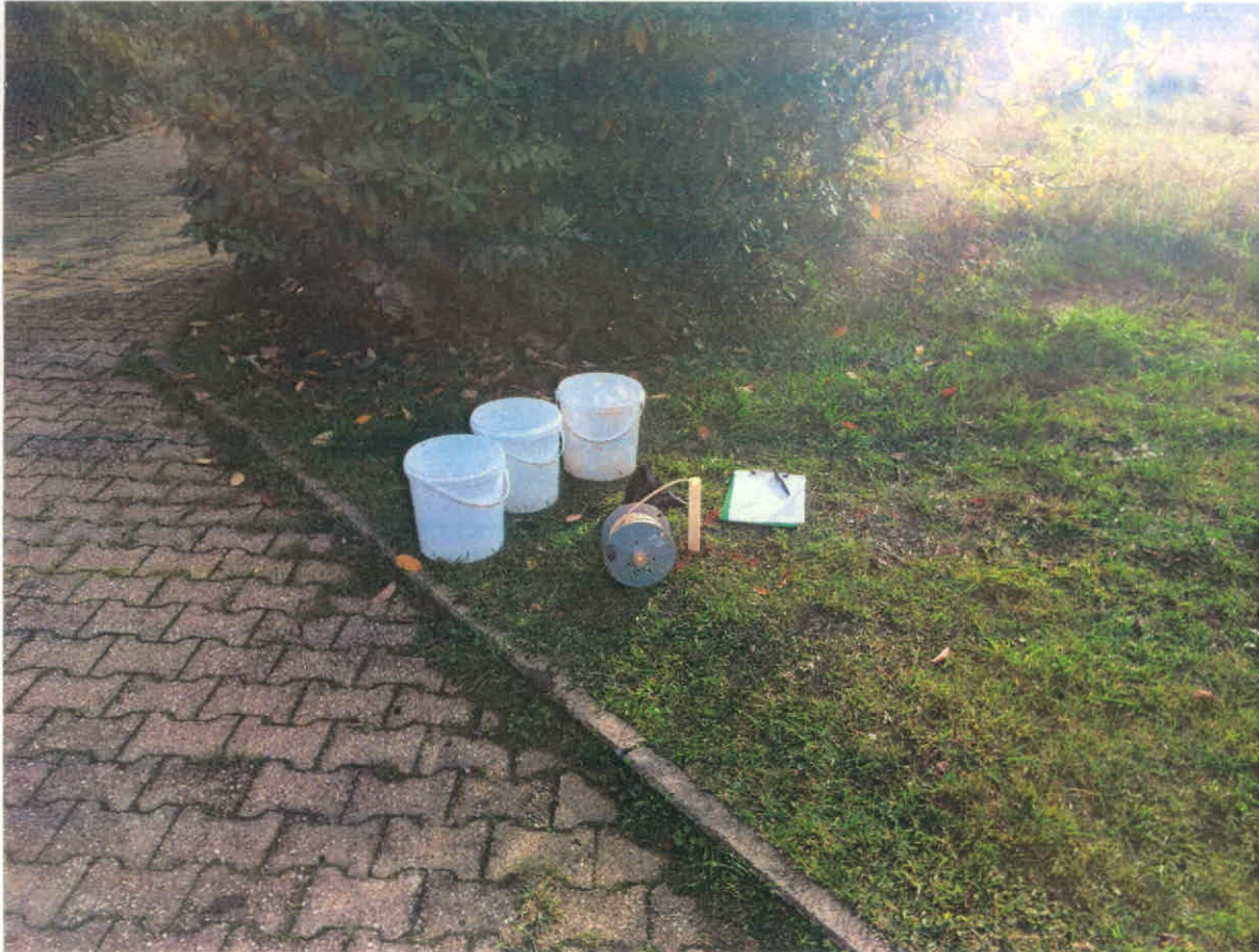
Bild 5: Ausführung des Versickerungsversuchs V1 im Bohrloch der RKS 1 am 10.10.2019
