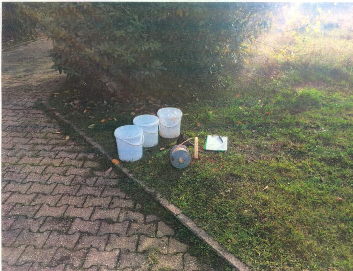
Bild 5: Ausführung des Versickerungsversuchs V1 im Bohrloch der RKS 1 am 10.10.2019
