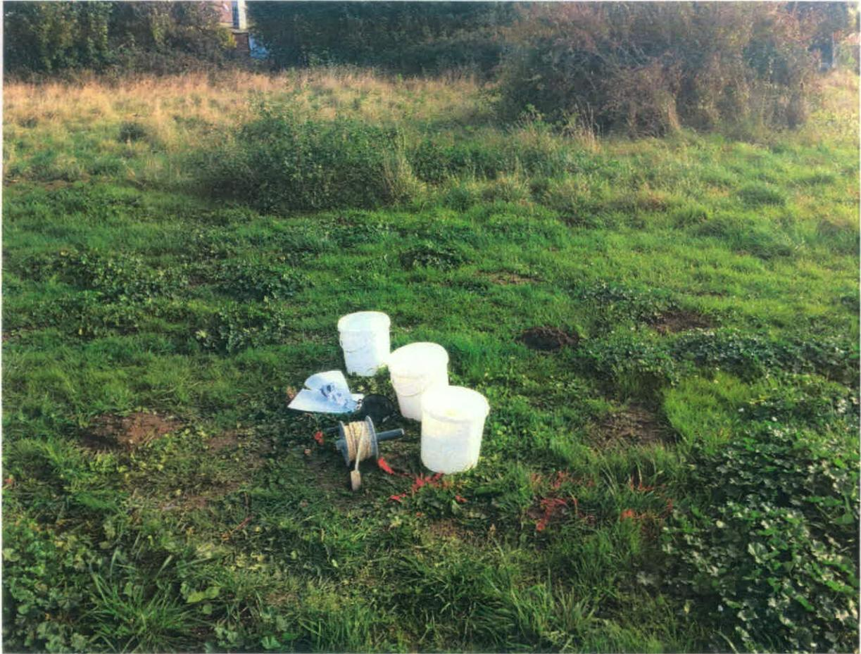
Bild 7: Ausführung des Versickerungsversuchs V2 im Bohrloch der RKS 2 am 10.10.2019
