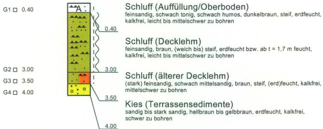
kein Bohrfortschritt bei t = 4,0 m, kein Wasser im Bohrloch
