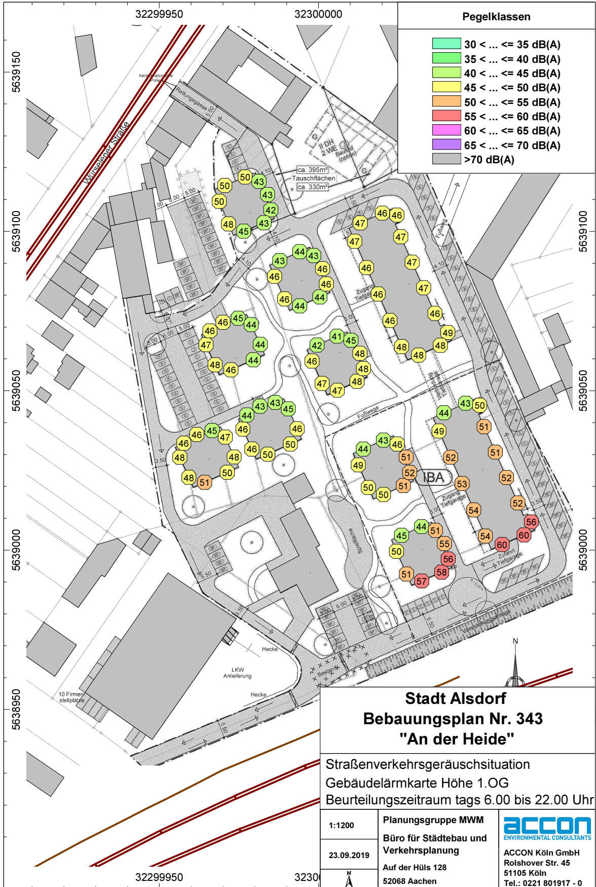
Abb. 4.3.1 Darstellung in einer Gebäudelärmkarte Höhe 1.OG, Betrachtung der Straßenverkehrsgeräuschsituation tags
