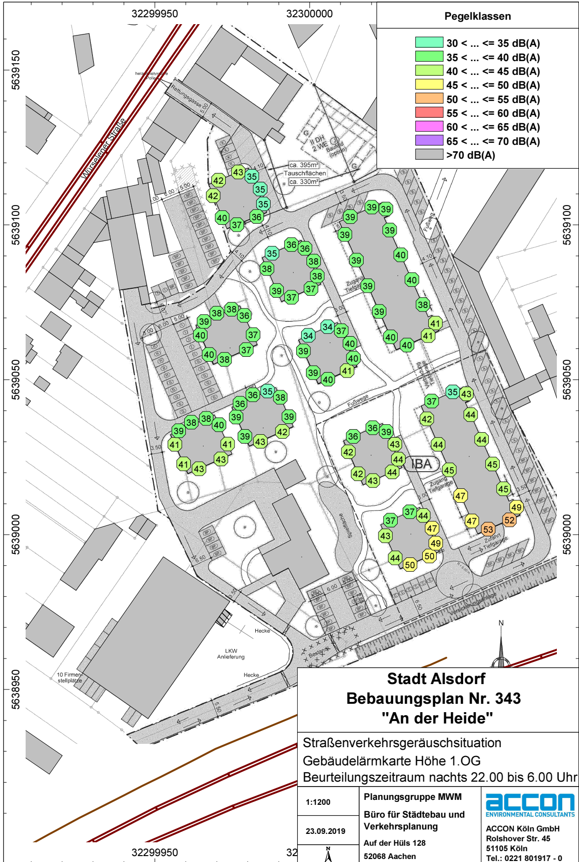
Abb. 4.3.2 Darstellung in einer Gebäudelärmkarte Höhe 1.OG, Betrachtung der Straßenverkehrsgeräuschsituation nachts
