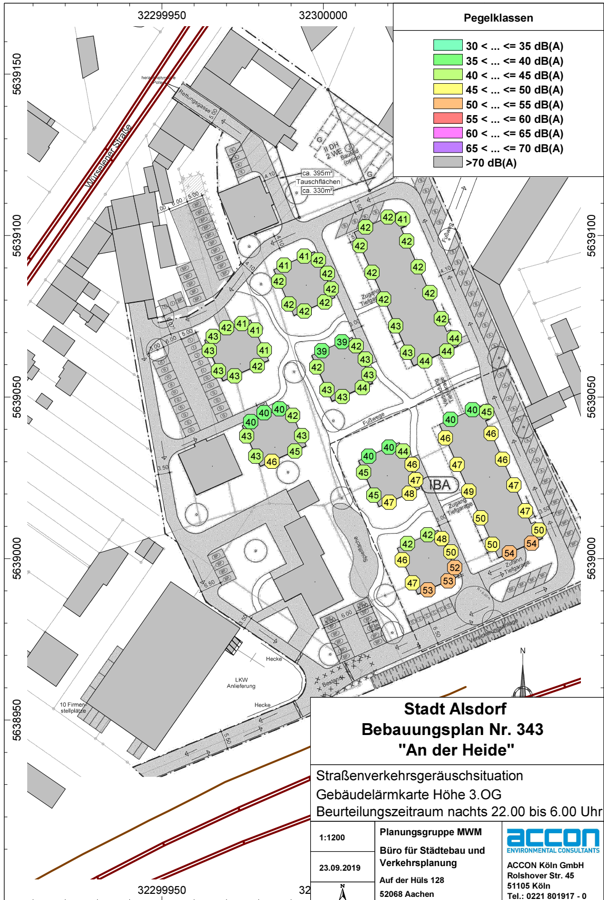
Abb. 4.3.4 Darstellung in einer Gebäudelärmkarte Höhe 3.OG, Betrachtung der Straßenverkehrsgeräuschsituation nachts
